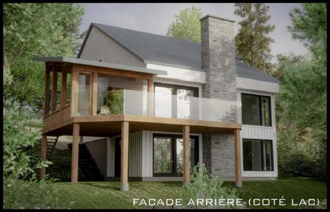
Les travaux consistent à remplacer le revêtement extérieur existant par des déclinés de pin horizontaux et verticaux de couleur blanc mât, de remplacer le revêtement de la cheminée par de la pierre et remplacer le bardeau du toit par une toiture d'acier prépeinte de couleur fusain.
