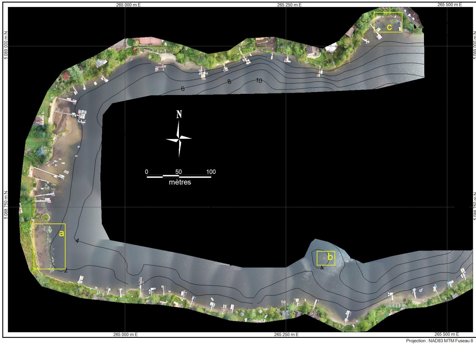
FIGURE 86. Ortho-mosaïque de l'extrémité ouest du lac de l'Achigan photographiée le 24 août 2018. Les lignes noires sont les isobathes paires (mètres) acquises en septembre 2000. Les rectangles jaunes montrent les positions des agrandissements présentés aux figures suivantes.
