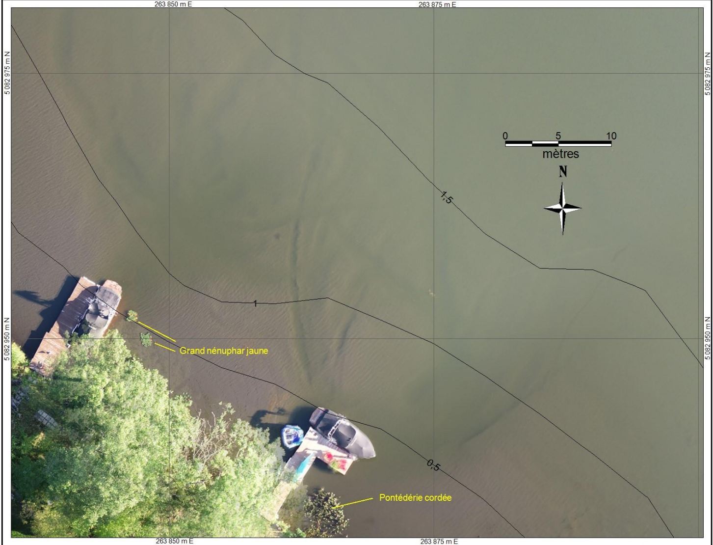
FIGURE 67. Ortho-mosaïque du secteur 6a au lac Écho montrant des sillons d'embarcations motorisées. Les lignes noires sont les isobathes 0,5 m acquises en 2018.
