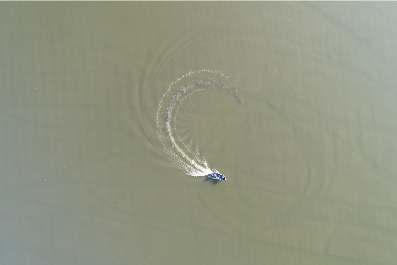
FIGURE 60. Petite embarcation responsable du panache de sédiments montré sur l'ortho-mosaïque précédente (figure 59). Noter la présence de multiples sillons causés par le passage d'autres embarcations motorisées.
