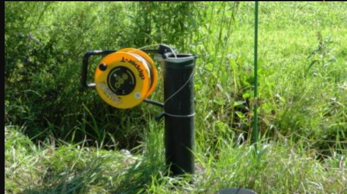
*Sonde piézométrique dans un puits*
